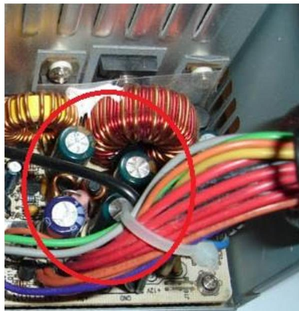
تو شکل زیر هم اگه توجه کنید یکی از خازن های خروجی سوخته
